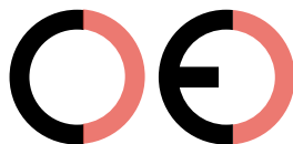
Faux marquage CE (trop éloignée)
